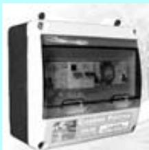
Cuadro de piscina que protege a la bomba contra sobretensiones y que a través de un reloj horario podemos prefijar el tiempo de funcionamiento de la depuradora, así como a través de un magnetotérmico unipolar podemos accionarla manualmente. Va montada en caja estanca IP55 con tapa transparente, provista de 12 elementos, con diferencial y mando para proyectores a través de 1 y 2 magnetotérmicos.
